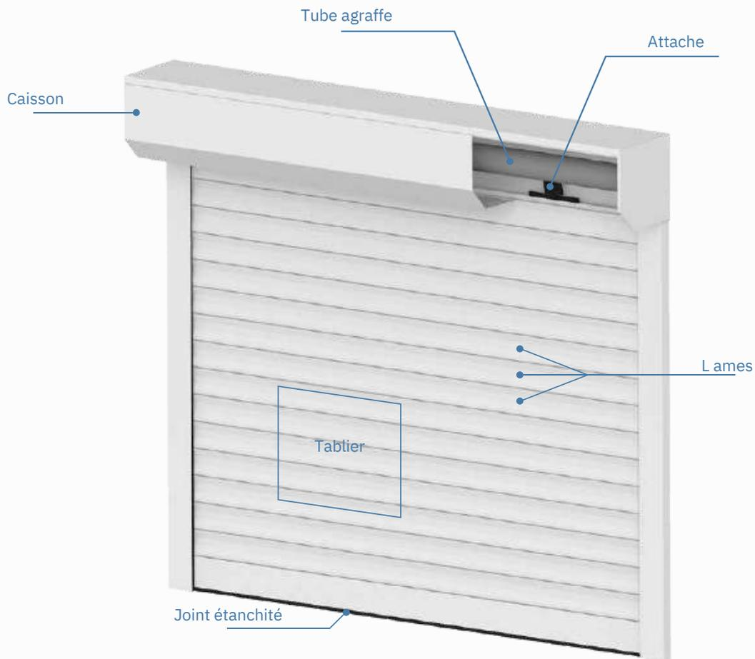
Volet roulant destiné à être installé à l'extérieur sans apporter de modification à la menuiserie ce qui le rend particulièrement adapté dans le cas d'une rénovation. Il est composé d'un coffre et de coulisses en aluminium laqué et d'un tablier en aluminium. Il est disponible en version manuelle ou motorisée.
